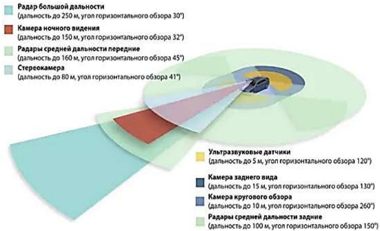
Рис. 1. Расположения датчиков в АТС [5]
