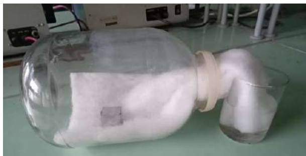
Рис. 1. Емкость для создания условий воздействия на образцы капиллярного смачивания
